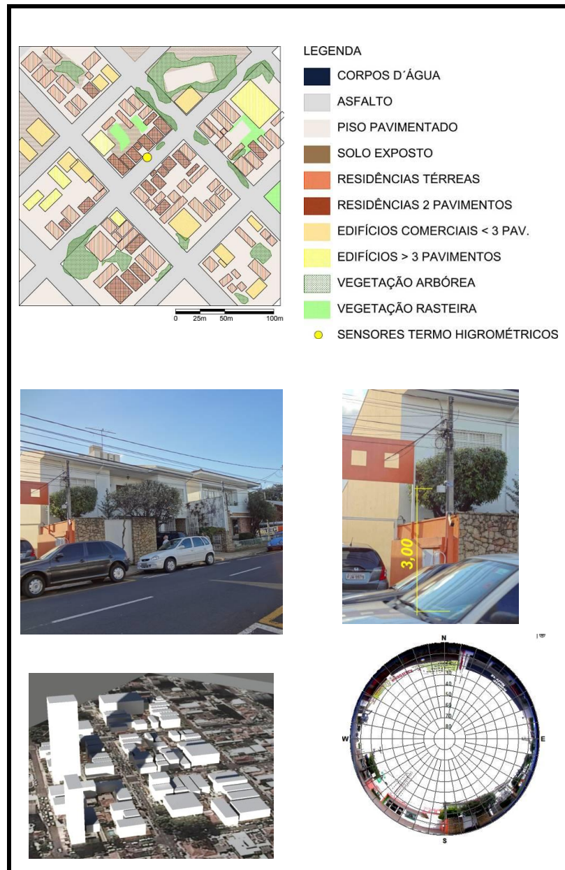
Figura 3 – Exemplo do conjunto de informações relativas à classificação de um ambiente urbano e o posicionamento do sensor termohigrométrico Fonte: adaptada de Google Earth (2013) e Matzarakis, (2014)
