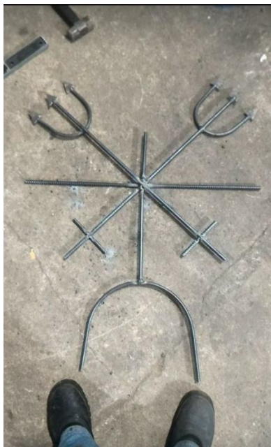
Figura 5: Peças do ferro sendo posicionadas antes da solda.
